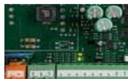
В левой нижней части контроллера расположены два светодиодных индикатора.
