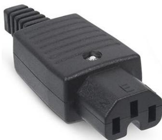
Вилка электрическая разборная ИЕС-320-С13 предназначена для установки на электрические кабели для подключения к оборудованию, имеющему гнездо С14. Вилка имеет 3 контакта винтового крепления: фаза, нейтраль и заземление. Имеет прижимную фиксацию внешней оболочки подключаемого кабеля. Разборный корпус позволяет осуществлять многократный монтаж/демонтаж разъема на кабеле без ухудшения характеристик.
