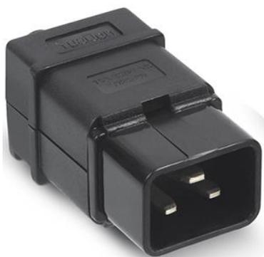
Вилка электрическая разборная ИЕС-320-С20 предназначена для установки на электрические кабели для их подключения к оборудованию, имеющему гнездо С19. Вилка имеет 3 контакта винтового крепления: фаза, нейтраль и заземление. Имеет прижимную фиксацию внешней оболочки подключаемого кабеля. Разборный корпус позволяет осуществлять многократный монтаж/демонтаж разъема на кабеле без ухудшения характеристик.
