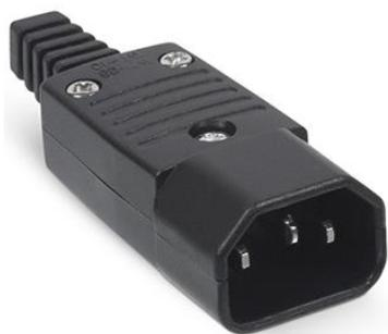
Вилка электрическая разборная ИЕС-320-С14 предназначена для установки на электрические кабели для подключения к оборудованию, имеющему гнездо С13. Вилка имеет 3 контакта винтового крепления: фаза, нейтраль и заземление. Имеет
