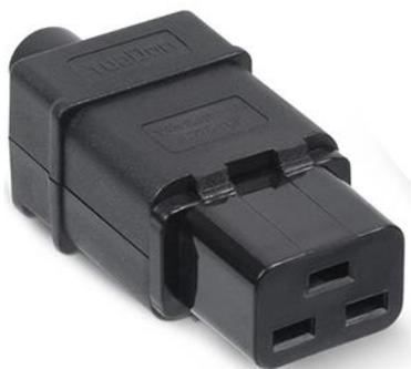
Вилка электрическая разборная ИЕС-320-С19 предназначена для установки на электрические кабели для их подключения к оборудованию, имеющему гнездо С20. Вилка имеет 3 контакта винтового крепления: фаза, нейтраль и заземление. Имеет прижимную фиксацию внешней оболочки подключаемого кабеля. Разборный корпус позволяет осуществлять многократный монтаж/демонтаж разъема на кабеле без ухудшения характеристик.
