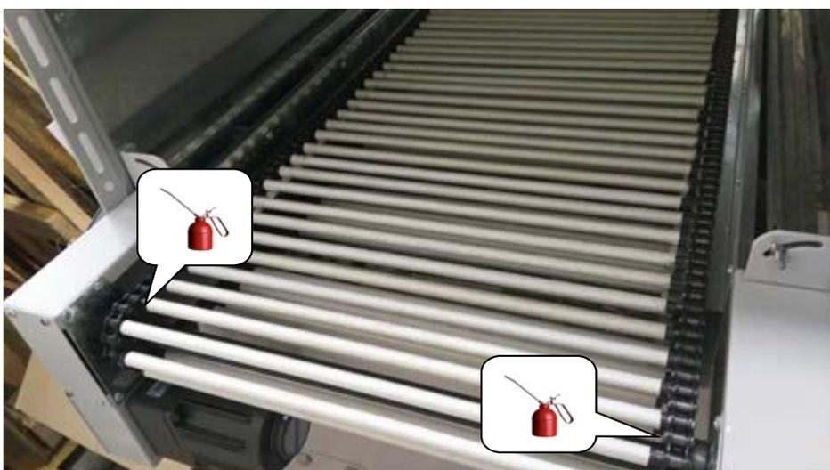
Смазывайте транспортерную цепь используя термостойкую смазку ЦИАТИМ-201 ГОСТ 6267-74.
