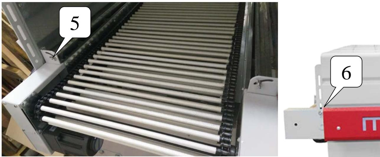
Тепловая камера снабжена заслонками регулировки потока для более эффективной упаковки различных видов продукции. Регулировка производится путем поворота ручек (5) со стороны выхода продукта. На входе и выходе тепловой камеры закреплены силиконовые шторки, снижающие утечку тепла из камеры. Так же, если пакуемый товар имеет небольшую высоту, камеру можно уменьшить, опустив ее корпус ниже с помощью винтов (6).
