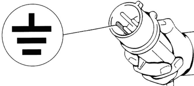
Перед тем, как подключить оборудование к электросети, убедитесь, что напряжение в сети соответствует напряжению, указанному в паспорте, и что оборудование заземлено в соответствии с действующими правилами техники безопасности.
