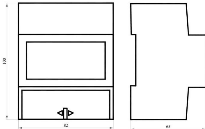
Счетчик устанавливается на DIN-рейку.
