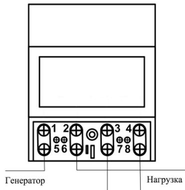
Импульсный выход ( $U < 24 \text{ В}$ ,  $I < 30 \text{ мА}$ )
