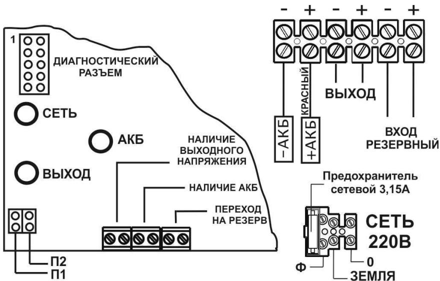
Рисунок 1. Вид источника с открытой крышкой (схема подключения)
