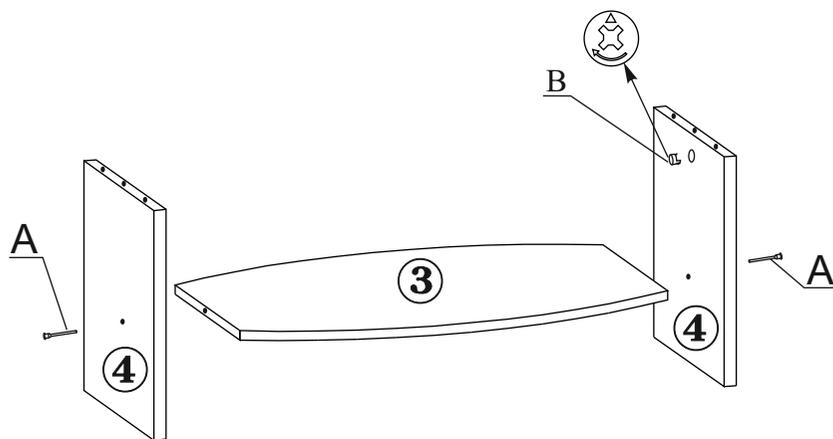
3.2. В столешницу (дет.№1) с нижней стороны закрутите штоки эксцентриков (поз.Б) и шканты (поз.Г). Соедините столешницу с полученной конструкцией из боковин (дет.№4) и полкой (дет.№3).
