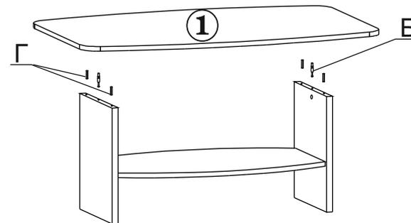
3.3. Установите царгу (дет.№5) соединив ее сполкой (дет.№3) шкантами (поз.Г). Присоедините основание (дет.№2), закрепив его винтовыми стяжками (поз.А). Снизу на основание установите мебельные колеса (поз.Е) при помощи шурупов.
