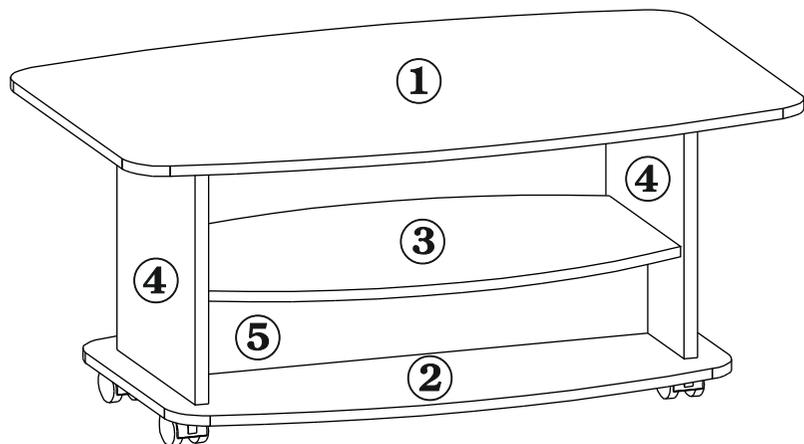
3.1. Соедините боковины (дет№4) и полку (дет№3) с помощью винтовой стяжки (поз.А) .Вставьте В отверстия в боковинах (дет.№ 4) эксцентрики (поз.В).
