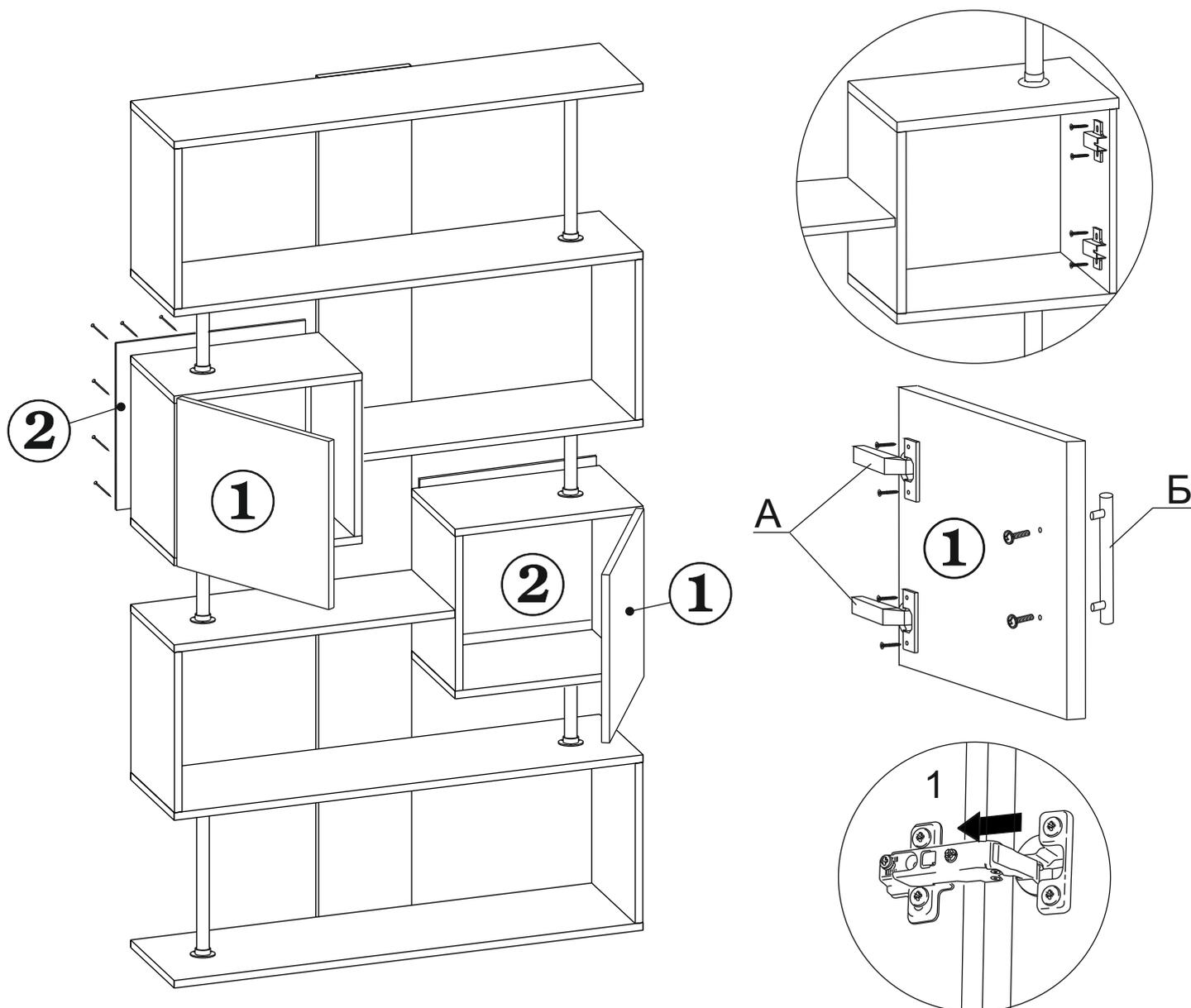
Закрепите шурупами на боковине ответные планки петель. Петли и ручки установите на дверях. Установите двери зафиксировав петли крепежным винтом на ответной планке. Отрегулируйте положение дверей. Гвоздями закрепите задние стенки.
