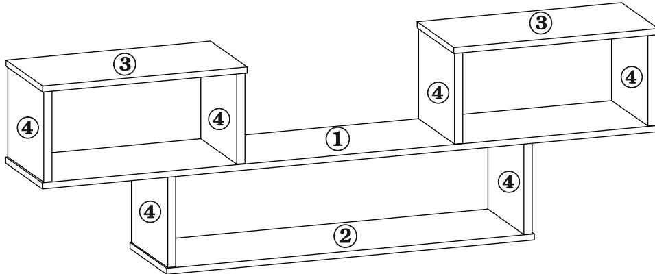
3.2. К детали №1 присоедините четыре детали №4 сверху при помощи Винтовой стяжки. Аналогичным способом закрепите две детали №4 расположив их снизу детали №1.
