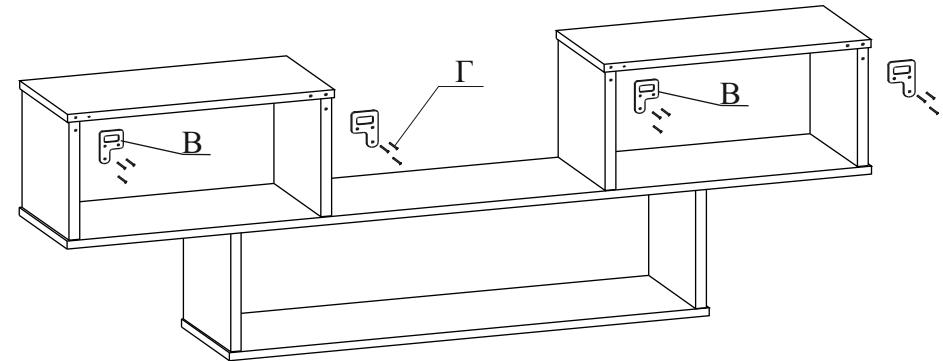
3.5. Разметьте место на стене для навески полки. Просверлите отверстия, забейте дюбеля, закрутите шурупы 4x40, повесьте изделие.
