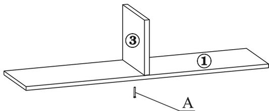
3.2. Разверните деталь №3 приблизительно на 25 - 30 градусов, так чтобы обеспечить доступ к отверстиям для крепления детали №3 снизу
