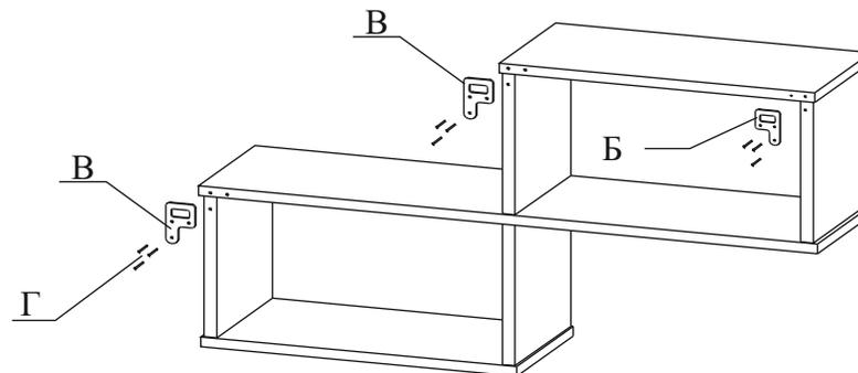
3.5. Разметьте место на стене для навески панели. Просверлите отверстия, забейте дюбеля, закрутите шурупы 4x40, повесьте изделие.
