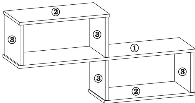
3.1. К детали №1 сверху присоедините деталь №3 используя одну Винтовую стяжку, используя отверстие в детали №1 расположенные ближе к тыльной стороне полки..
