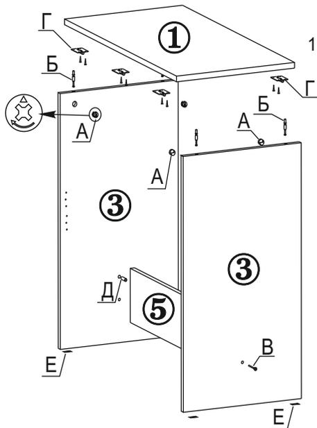
1.1. В отверстия на столешнице (дет.№1) закрутите штоки эксцентриков (поз.Б), шурупами 3,5х16 закрепите карточные петли (поз.Г), вставьте полкодержатели.
