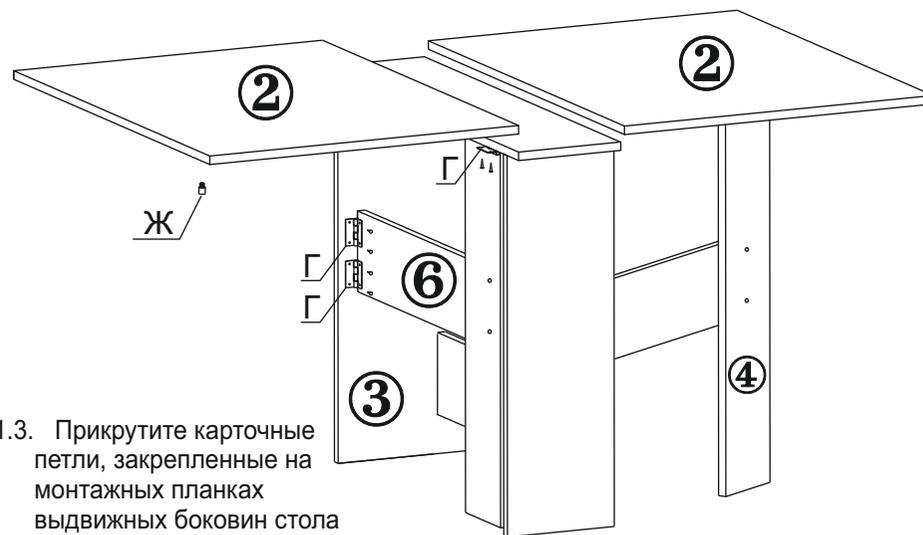
1.3. Прикрутите карточные петли, закрепленные на монтажных планках выдвижных боковин стола к боковинам стола.
