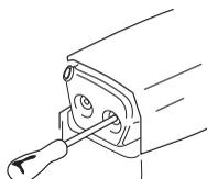
В некоторых глушителях предусмотрен специальный искрогаситель. Если ваша машина оборудована таким глушителем, сетку фильтра следует чистить раз в неделю. Наилучшие результаты дает использование стальной щетки. Забитая решетка приводит к работе с горячим двигателем, что дает серьезные повреждения двигателя.
