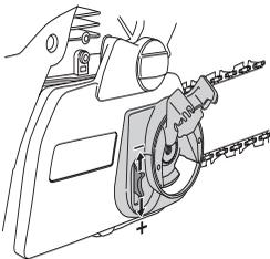
Цепь натянута правильно, если она не провисает под направляющей, но ее можно свободно повернуть вручную. Придерживая носовую часть направляющей, затяните ее сцепление, поворачивая ручку по часовой стрелке.
