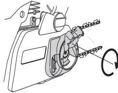
При установке новой цепи следует часто проверять ее натяжение, пока цепь не приработается. Регулярно проверяйте натяжение цепи. Правильно натянутая цепь обеспечивает высокое качество пиления и дольше служит.
