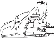
Зажигание; подсос (А): Установите рычаг подсоса в положение подсоса. Выключатель при этом должен автоматически перейти в положение пуска.
