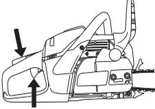
После того, как двигатель сделает первую вспышку, верните сразу рычаг воздушной заслонки в первоначальное положение, открывая воздушную заслонку, и повторите запуск. Когда двигатель запустится, дайте полный газ и отпустите рычаг дроссельной заслонки и блокировка пускового положения дроссельной заслонки отключится.
