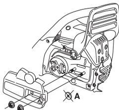
Установите пильное полотно на специально предназначенные болты. Установите полотно в самое заднее положение. Оденьте цепь на ведущую звездочку и вставьте ее хвостовики в паз пильного полотна. Начините с верхней стороны пильного полотна.
