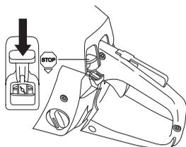
Двигатель останавливается путем выключения зажигания.
