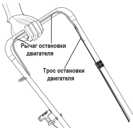
Рис. 7 Проверка работы троса остановки двигателя
