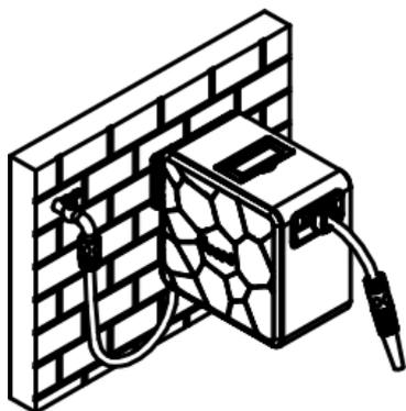
чтобы отверстия в настенном кронштейне и отверстия в шланговом ящике находились друг над другом, а затем вставьте соединительную трубу в эти отверстия.
