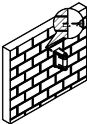
Выберите желаемое место на стене / стене, которую нужно прикрепить. Отметьте отверстия и просверлите их для поставляемых дюбелей или подходящих крепежных материалов
