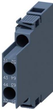
Вспомогательный выключатель сбоку, 1 НО + 1 НЗ Токопровод 1 НЗ, 1 НО для 3RH2 и 3RT2 Винтовой зажим R: 31/32, 43/44 L: 51/52, 63/64
