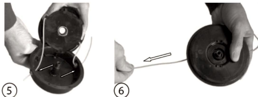
Вставьте концы лески в отверстия на корпусе катушки. Установите шпульку в корпус катушки (5). Освободите концы лески, потянув за концы от центра (6). Установите катушку на триммер.
