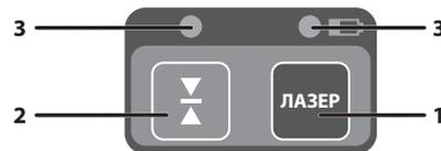
1. Кнопка «Лазер» включения горизонтальной и вертикальной линии
