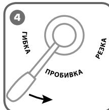
Поверните рычаг распределения потока рабочей жидкости в нужное положение в соответствии с указателями
