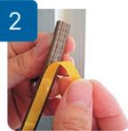
Постепенно снимаем с уплотнителя защитную ленту небольшими участками (10-15 см). Приклеиваем, начиная с верхней части окна/двери, равномерно прижимая клеящий слой к поверхности.
