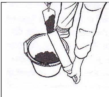
Заполнить корпус составом и установить на место. Нажимать на спусковой рычаг до тех пор, пока плунжер не соприкоснется с составом. Теперь пистолет полностью готов к работе.
