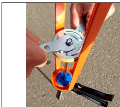
Плунжер регулируется в зависимости от износа. Плотное примыкание резинового уплотнения в корпусе регулируется затягиванием гаек. Примечание: если плунжер с трудом перемещается даже в увлажненном состоянии, он может быть перетянут; ослабление гаек может решить проблему.
