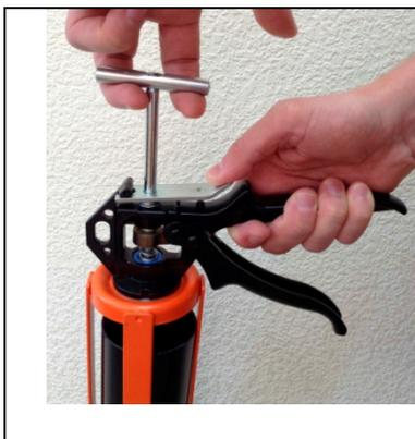
Надавить на пластину в задней части пистолета и оттянуть Т-образный шток, чтобы вынуть плунжер из корпуса; снять корпус. Если шток не вынимается из-за того, что он сухой, влейте в корпус немного воды.
