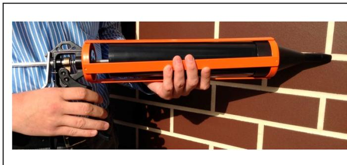
Ultrapoint работает как пистолет для нанесения герметика – приложением постоянного усилия к спусковому рычагу. Механизм достаточно мощный, и приложения избыточного усилия не требуется.
