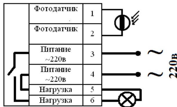
Рис. 3. Типовая схема подключения фотореле к сети 220в.
