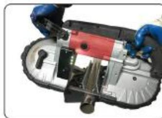
Держите инструмент двумя руками, как показано на рисунке; при этом стопорная пластина контактирует с рабочей заготовкой, а полотно пилы находится на расстоянии от заготовки.
