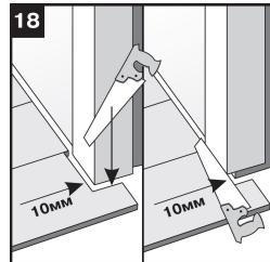
19. Иногда в укладке ламината возникает ситуация невозможности установки панели из-за помехи. В этом случае необходимо спилить часть замка и закрепить панель при помощи клея для ламината.
