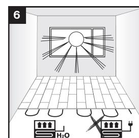
7. Если вы укладываете ламинат на бетонное основание, то Вам потребуется гидроизоляционная пленка, для обеспечения пароизоляции от остаточной влажности вашей стяжки. Уже после этого расстилается специальная звуко- и гидропоглощающая подложка, дополнительно обеспечивающая вентиляционный эффект вашей стяжки. После этого осуществляется монтаж ламината.
