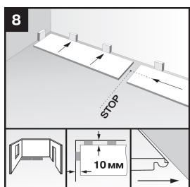
9. После формирования первого ряда приступаем ко 2-му ряду. Монтаж второго ряда производится со смещением не менее в 1/3 длины половицы (в зависимости от рисунка декора). **Панель второго ряда подносится к другой панели под углом 25 градусов, вставляется в замок и защелкивается.** Замки на торцах защелкиваются после того, как будут состыкованы и подогнаны продольные замки.
