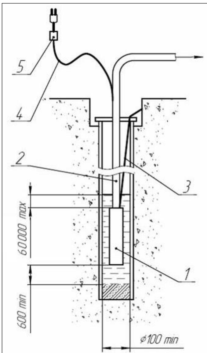
Схема 1 Установка насоса
