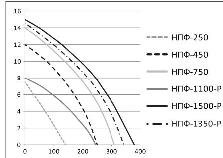
■ производительность насоса напрямую зависит от напора (высоты подъема воды). Не рекомендуется использовать насос при максимальном напоре – в этом случае подача воды будет минимальна (см. график ниже);
