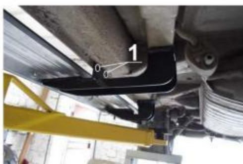
Рис.7 Разметка крепёжных отверстий
