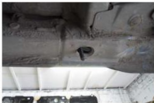
Рис.8 Место крепления заднего кронштейна
