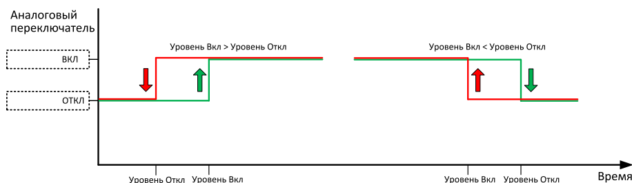
Изображение 5.29 Принцип работы аналогового переключателя
