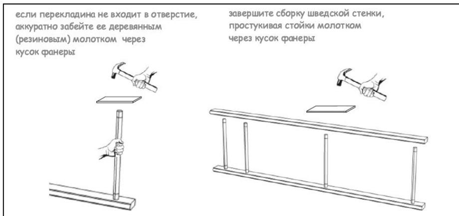
4.2.3. Разложить зеркально стойки (№1). Вставить ступени-поперечины (№9) в соответствующие отверстия стоек (№1) (рисунок 2). С помощью саморезов (№10) и шайб (№11) закрепить поперечины к стойкам. Установить заглушки (№12) (рисунок 1).
