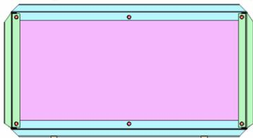
6. Установить крышку ящика, по углам с помощью болтов, гаек и шайб.
