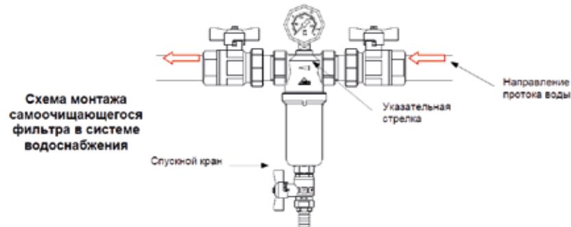
При монтаже фильтров не допускается превышать предельный крутящий момент в 35 Нм.
