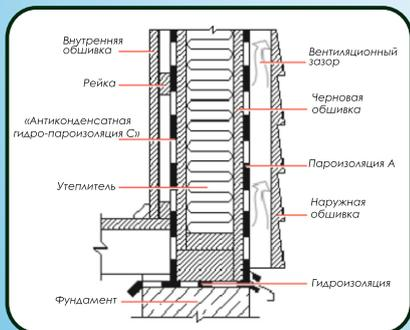
В **КАРКАСНЫХ СТЕНАХ** «Антиконденсатная гидро-пароизоляция С» укладывается непосредственно на внутренней поверхности стены шероховатой стороной внутрь помещения. Для монтажа пароизоляции на кирпичных или блочных стенах применяется соединительная лента «SL». Затем материал закрепляется контррейками или оцинкованными профилями, на которые устанавливается внутренняя обшивка (вагонка, декоративные панели, гипсокартон и т.д.).
