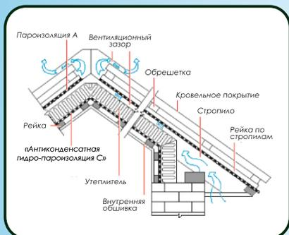
В **УТЕПЛЕННЫХ КРОВЛЯХ** и стенах «Антиконденсатная гидро-пароизоляция С» укладывается с внутренней стороны утеплителя на элементы несущего каркаса (стойки, балки, стропила) или по черновой обшивке при помощи оцинкованных гвоздей или строительного степлера. Укладка пароизоляции производится с **плотным прилеганием гладкой стороной к утеплителю**.
