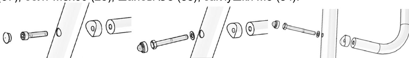
**Рис.3 – Сборка вертикальных стоек, перекладин и крепление Г-образного усиления.**
