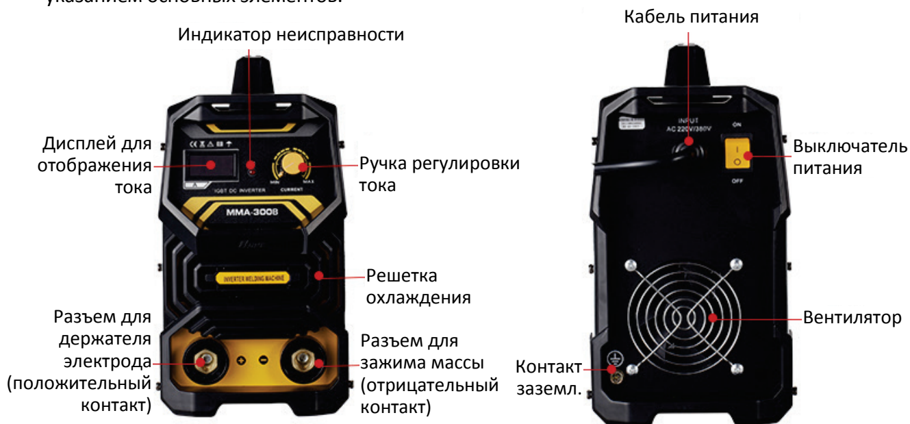
Рис. 2. Инверторный сварочный аппарат моделей ММА-200В/250В/300В. Основные элементы.
