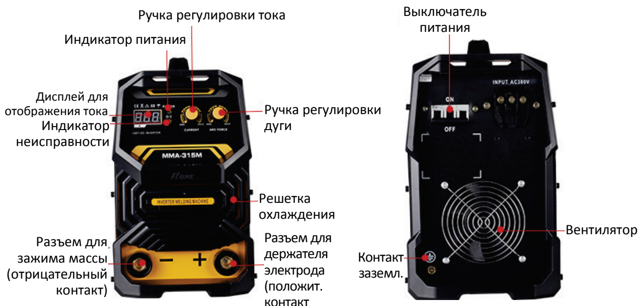
Рис. 3. Инверторный сварочный аппарат моделей MMA-250M/280M/315M. Основные элементы.
