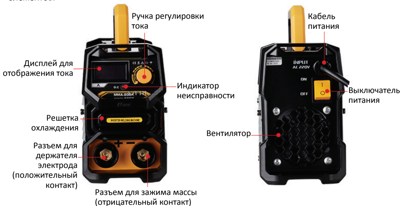
Рис. 1. Инверторный сварочный аппарат МА-200А. Основные элементы.
