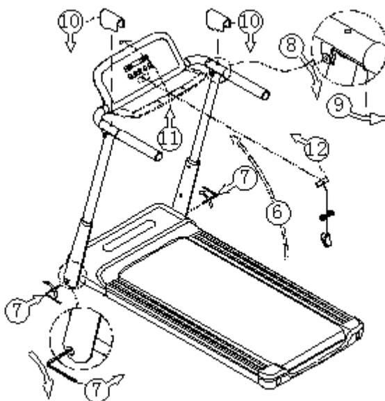
Как показано на шаге 6, установите левую и правую стойки так, чтобы поднять их вверх до предельного положения (где установлен предельный уровень).
