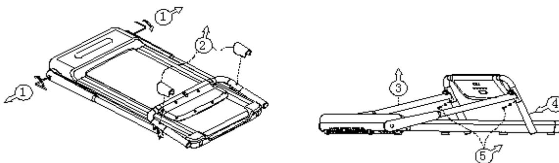
Достаньте беговую дорожку из коробки. Как показано на шаге слева, вставьте в отверстие под левой и правой стойками 6-миллиметровые ключи и поверните против часовой стрелки 3-4 раза, выравнивая отверстия для винтов. Как показано на шаге 2, достаньте крышку рукоятки, прикрепленную на пересечении левой и правой рукояток, и отложите ее для последующего использования.
