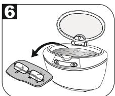
Если нужно продолжить очистку, достаточно повторить предыдущие шаги. Во время очистки, для ее остановки нажмите кнопку «⌚» (и удерживайте ее более 3 секунд). Если нажать кнопку «⌚» снова, очиститель продолжит очистку. Вы можете так же нажать кнопку «⌚» для выбора нового цикла очистки.
