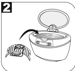
Энергия ультразвука очень велика, не погружайте часы в воду полностью (если степень их водозащиты менее 30 метров), иначе вода проникнет в механизм. В этом случае используйте стенд для часов, в воде должен находиться только ремешок. Корпус часов должен находиться над водой.
