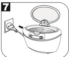
Когда очистка закончена, отключите прибор от сети, откройте крышку и извлеките очищенные детали. Слейте грязную воду, вымойте бак и протрите его.
