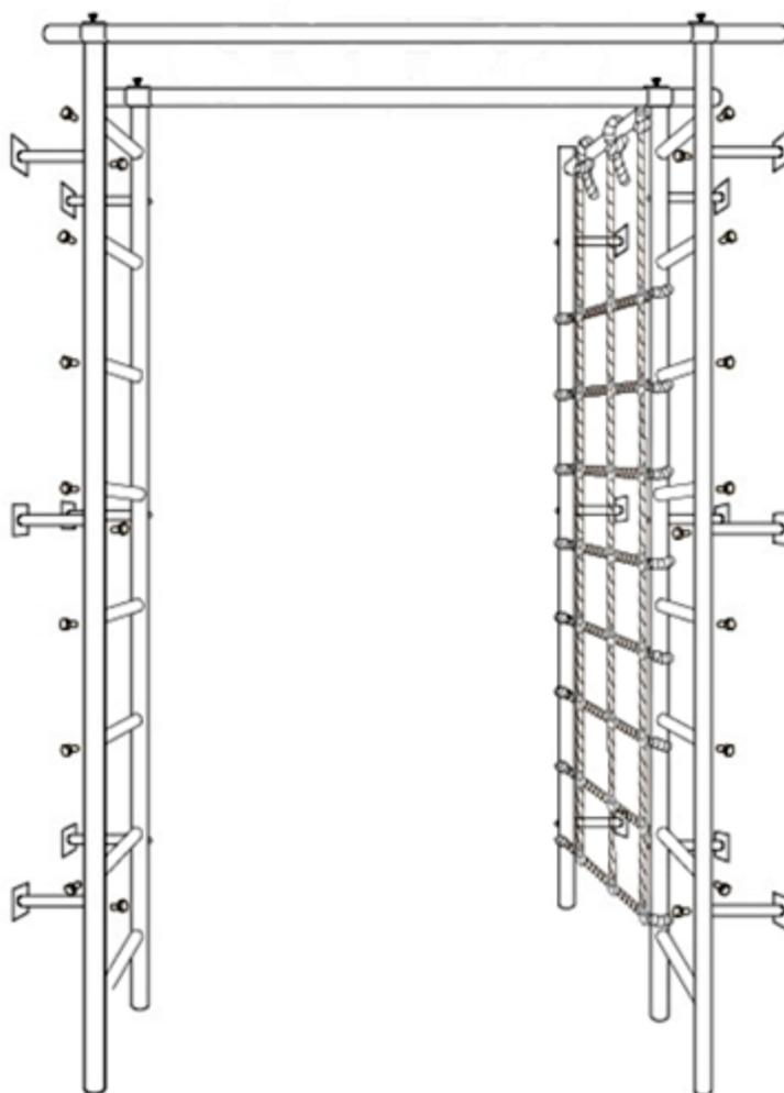
Закрепить лестницу к стене с помощью анкеров и дюбелей. Закрепить таким же способом верхнюю раму к стене. Завернуть прижимные болты верхней рамы в проушьях лестницы.
