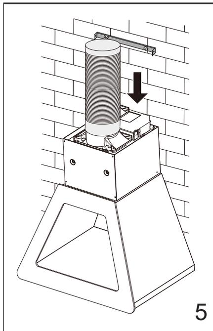
Соедините воздуховод (не идет в комплекте) с фланцем обратного клапана и выведите его в вентиляционную шахту помещения.
