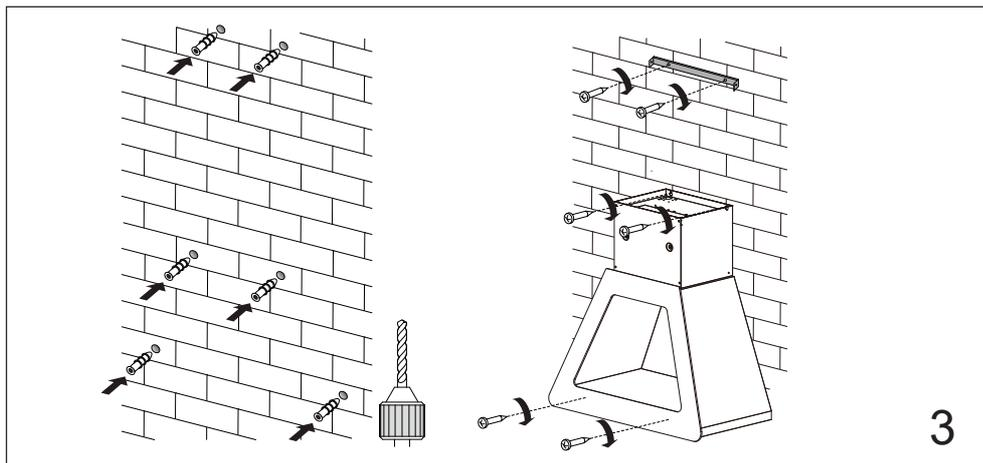
По произведенной разметке просверлите отверстия в стене, используя сверло 8мм. Установите дюбеля в отверстия. Используя крепеж в комплекте к вытяжке, зафиксируйте вытяжку на стене в месте установки.
