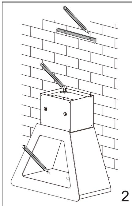
Рекомендуем демонтировать жировой фильтр с вытяжки до начала установки. Это позволит уверенно оперировать вытяжкой при разметке места установки, примерке и при непосредственной установке. Оптимально производить работы по установке вытяжки **вдвоем**.
