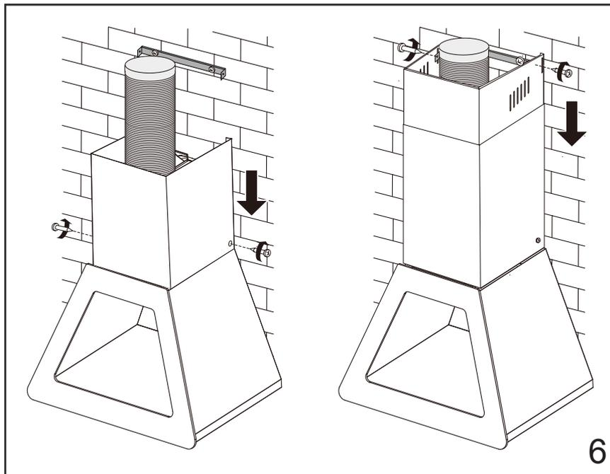
Закрепите нижний кожух на корпусе мотора вытяжки, используя рекомендованный крепеж.
