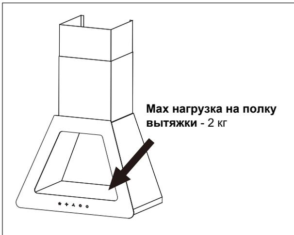
Размещение тяжелых предметов на полке может привести к деформации корпуса вытяжки, ослаблению крепежа, последующему падению вытяжки со стены и **снятию с гарантии производителя.**
