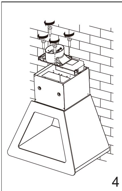
Смонтируйте обратный клапан на верхней части корпуса мотора вытяжки, как показано на рисунке. Надежно, но без лишних усилий, затяните крепеж, не повредив пластиковый корпус обратного клапана.
