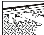
1. Демонтируйте светодиодный светильник, используя отвертку с плоским шлицем.
