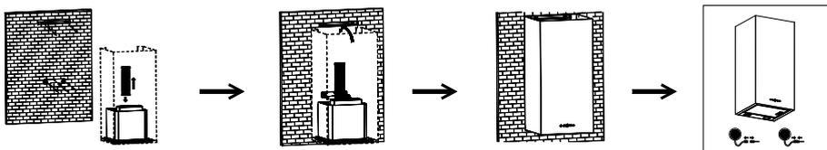
1. Прикрепите монтажный кронштейн и кронштейн дымохода к стене соответствующими винтами.
