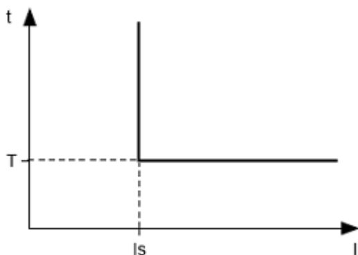
Рисунок 1.4. Принцип защиты с независимой выдержкой времени
