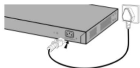
Подключение питания AC 100~240В
