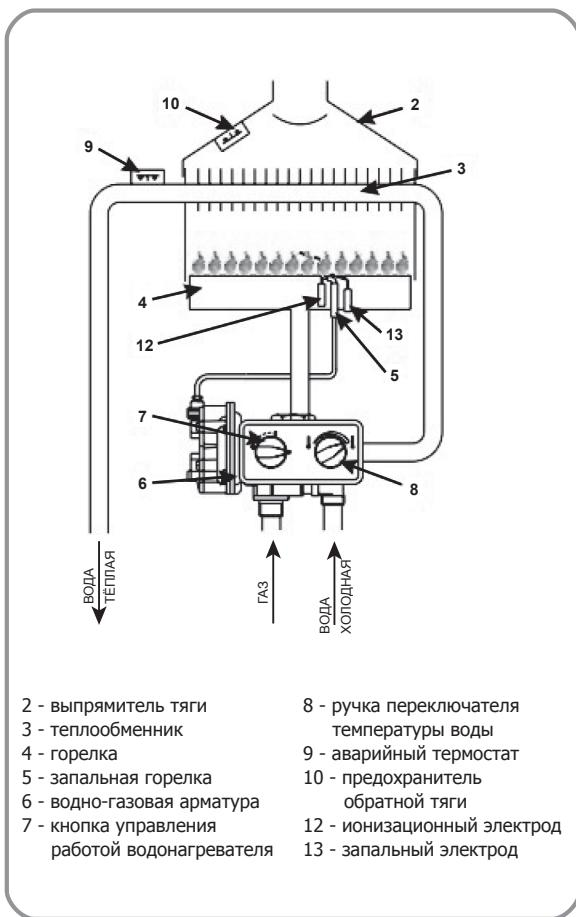
Основной функциональной частью водонагревателя является узел, состоящий из совмещенной компактной универсальной водно-газовой арматуры, газовых основной и запальной горелок. Над основной горелкой расположен теплообменник, обеспечивающий передачу тепла от продуктов сгорания в протекающую воду.
