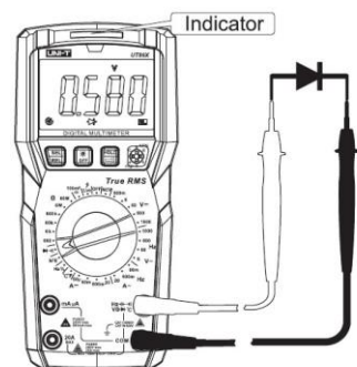
Хороший диод (прямое включение)
