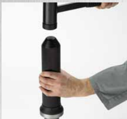
Правильная работа инструмента для монтажа подшипников.
