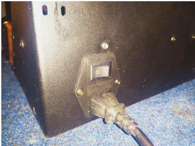
3D-принтер работает от сети 220 вольт. Рекомендуется подключение к источнику бесперебойного питания (ИБП), особенно если в месте установки напряжение нестабильно и возможны скачки напряжения.
