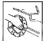
6. Начинайте полировку с больших участков таких как капот, колодки И крыша. Во время работы перемещайте равномерно инструмент ПО обрабатываемой поверхности, не нажимая на него полировальной (собственного веса машины достаточно получения необходимого ДЛЯ результата работы).
