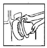
5. Для менее доступных поверхностей (например зеркала заднего вида, бамперы, ручки дверей и т.д.) снимите полировальную накладку и используйте ее для ручной полировки.
