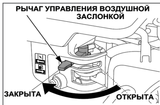
Рис.10 - Воздушная заслонка закрыта
