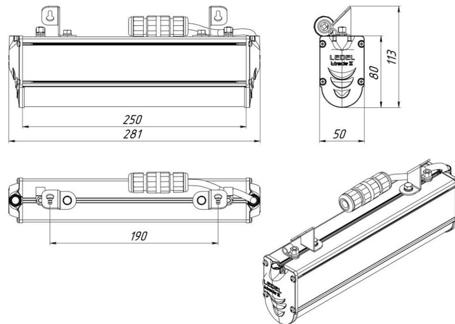
Рисунок 1 Светильник «L-trade II 12 с фиксированным угловым креплением»
