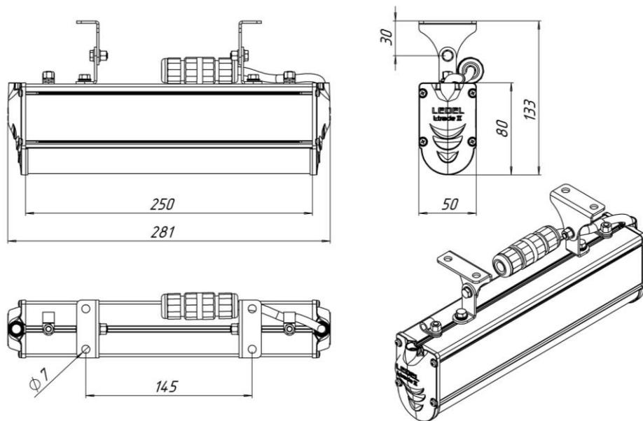
Рисунок 2 Светильник «L-trade II 12 с поворотным креплением»
