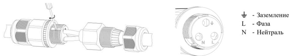
**6. Плотно закрутить крышку разъема и зажимную гайку обеспечив герметичность.**
