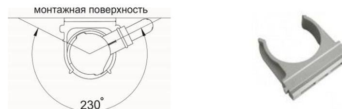
Рисунок 1 Варианты крепления и диапазон регулировки монтажа
