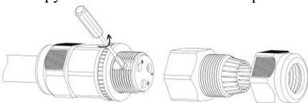
**5. Продеть кабель через крышку с зажимной гайкой. Зачищенные провод вставить в отверстие на разъеме так, чтобы только оголённая часть провода оказалась внутри клеммы. Подключение проводов в разъеме производить строго в соответствии с обозначением на торцевой поверхности центральной части коннектора. Закрепить провода в клеммах закрутив винты клемм.**
