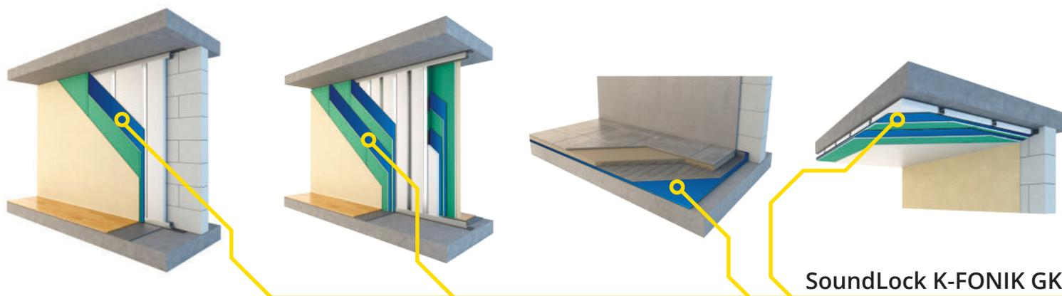
▲ Звукоизолирующая облицовка стены ▲
