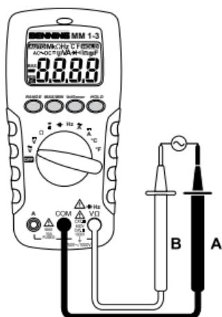
Bild 3: Wechselspannungsmessung
