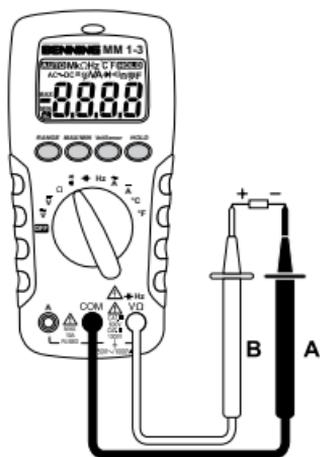
Bild 8: Durchgangsprüfung mit Summer
