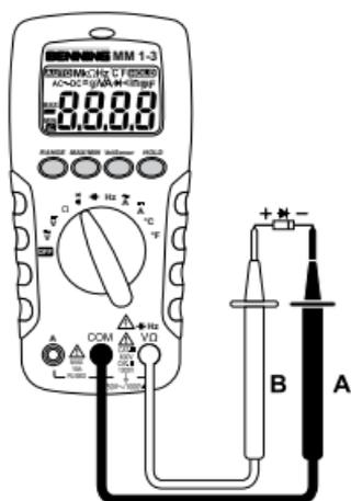
Bild 7: Diodenprüfung
