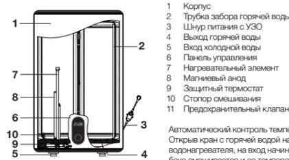
Автоматический контроль температуры воды: Открыв кран с горячей водой на смесителе на выходе водонагревателя, на вход начинает поступать холодная вода. Вода в баке смешивается и ее температура понижается. Датчик термостата реагирует на понижение температуры воды, автоматически включается нагревательный элемент (ТЭН) и подогревает воду до заданной температуры. Когда температура достигнет заданной величины, ТЭН автоматически отключается.
